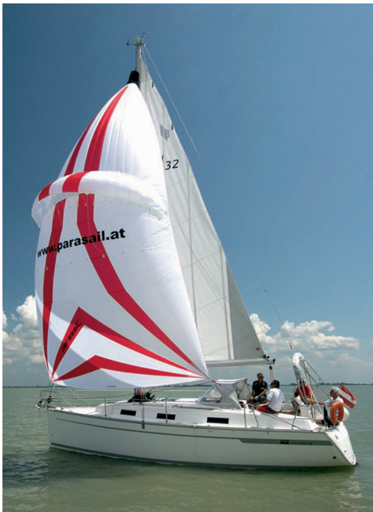
Wingaker. Statt eines Flügels ist dieses Segel mit einer angenäherten Lufthutze ausgestattet. Die starke Krümmung des Auftriebs-elementes stabilisiert das Segel, seine Anbindung an den oberen Segelteil reduziert den Druckverlust
