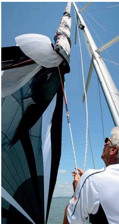
Wingaker. Statt eines Flügels ist dieses Segel mit einer angenäherten Lufthutze ausgestattet. Die starke Krümmung des Auftriebs-elementes stabilisiert das Segel, seine Anbindung an den oberen Segelteil reduziert den Druckverlust
