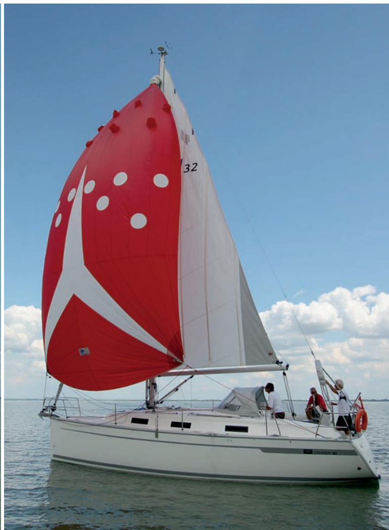
Paraspi. Es gibt weder Lufthutze noch Flügel, sondern im oberen Segelbereich Löcher mit nach außen gestülpten, ca. 15 cm langen Nylonschläuchen. Diese sollen Roll- und Geigebewegungen verhindern und Böen die Härte nehmen
